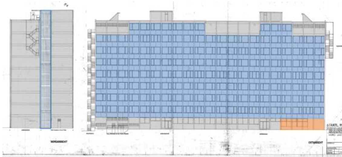
Übersicht Fassadentypen Süd- und Ostansicht
